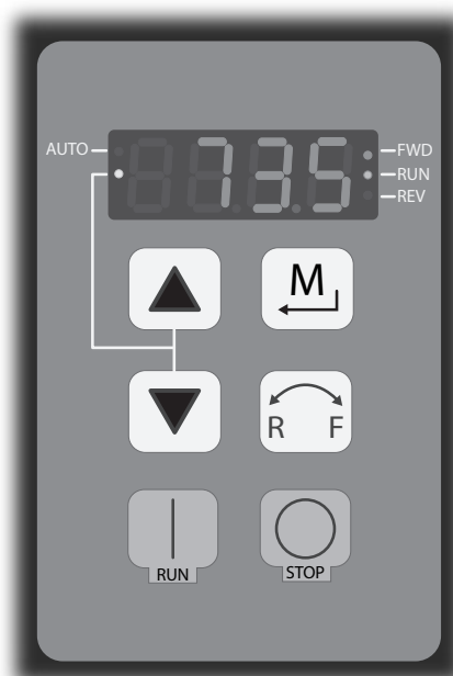
Affichage du pourcentage de la vitesse du ventilateur (73,5 % en marche avant)
